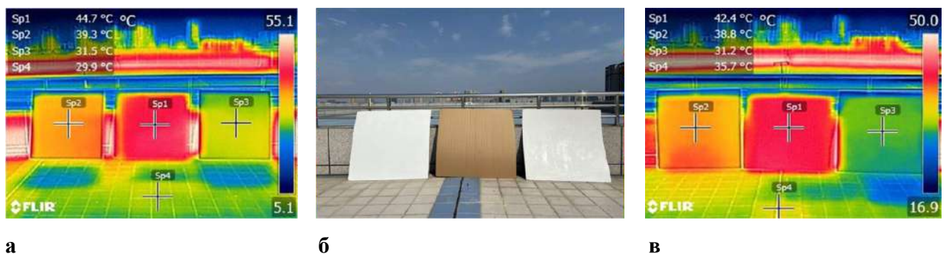
Рисунок 14 а – инфракрасные тепловизионные изображения коммерческого покрытия (Sp2), картонной подложки (Sp1) и покрытия \text{Ca}_3(\text{PO}_4)_2 (Sp3), б – фотографии тестируемых покрытий, в – инфракрасное изображение трех покрытий после 20-дневного воздействия [171, с. 22].
