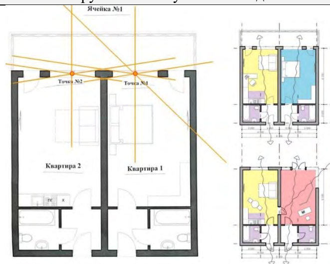
Рисунок 93. Проверка инсоляции «ячейки №1» и потоков воздуха при разных вариантах функционального насыщения.
