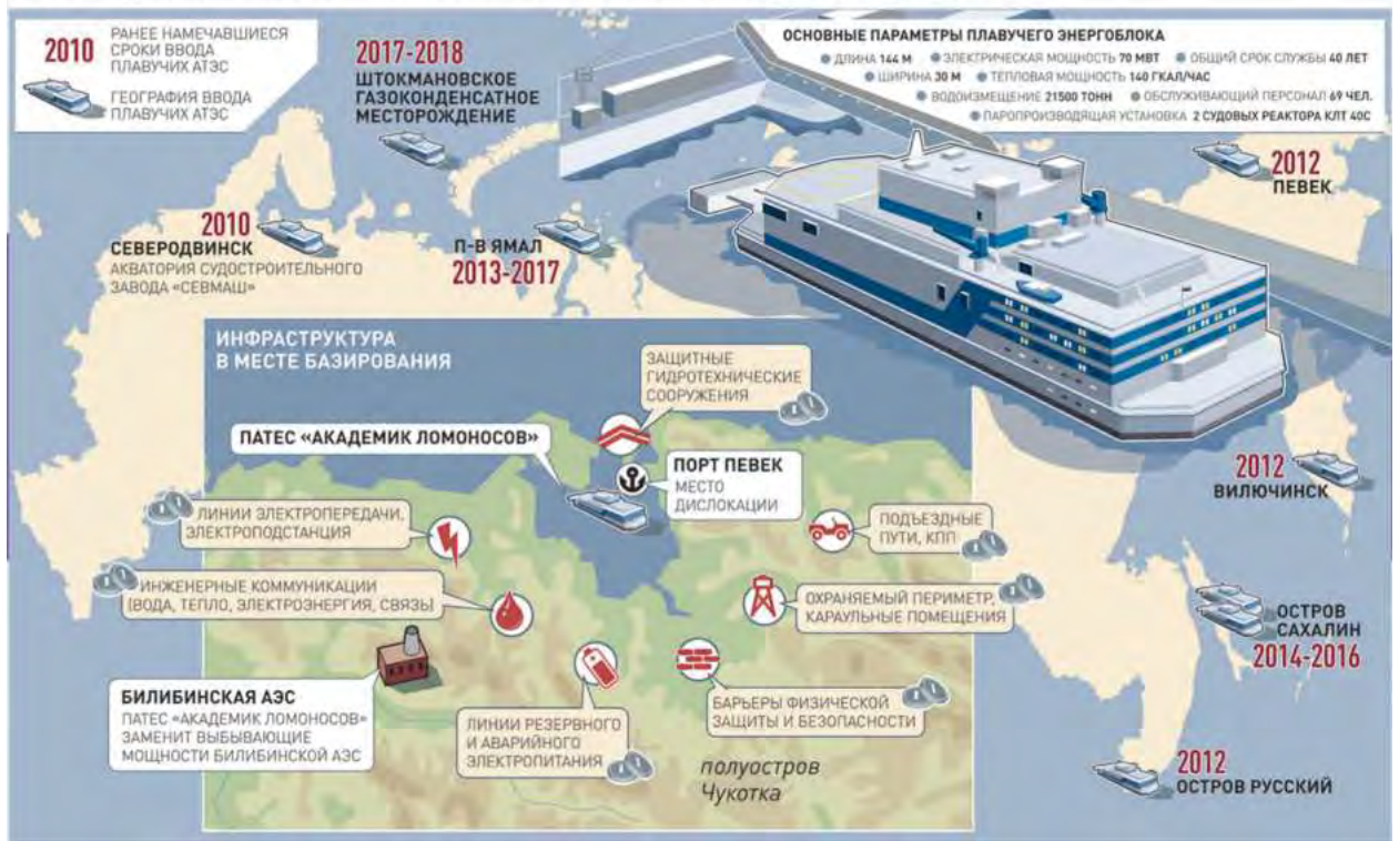
98. ПАТЕС «Академик Ломоносов» и схема его расположения
